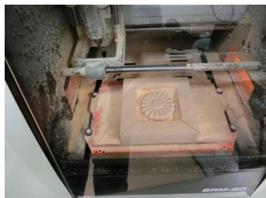
卓上切削加工機による切削加工の様子
