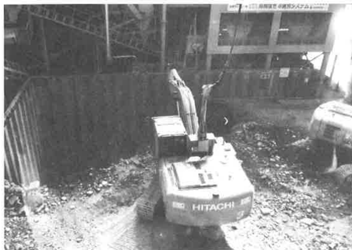
電動式大型重機（車体上部に電力ケーブル）
